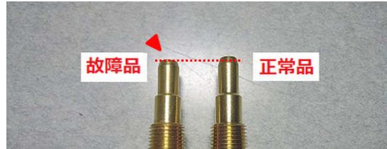
先端がつぶれ、内部の温度センサーが故障
