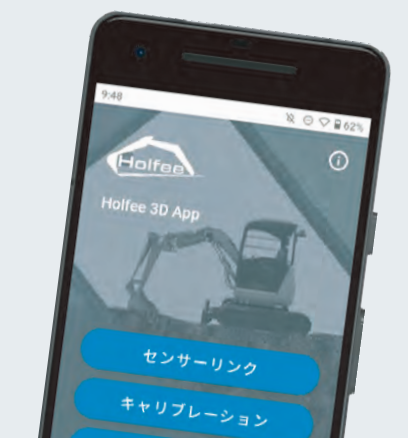
使用イメージ：スマートフォンのアプリ画面に3Dでショベルの掘削位置を表示
