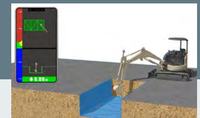
使用イメージ：スマートフォンのアプリ画面に3Dでショベルの掘削位置を表示
